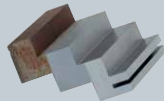
Erodierte Oberflächen im 2-Stufen-Verfahren gestrahlt
