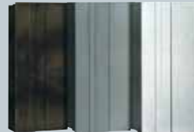
Erodierte Oberflächen im 2-Stufen-Verfahren gestrahlt
